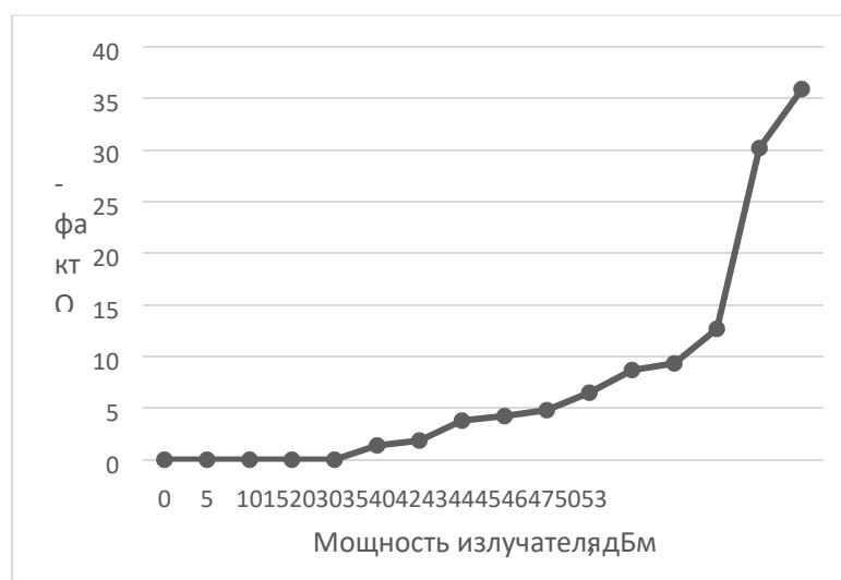
Рисунок 2.10 - Зависимость Q-фактора от мощности излучателя
